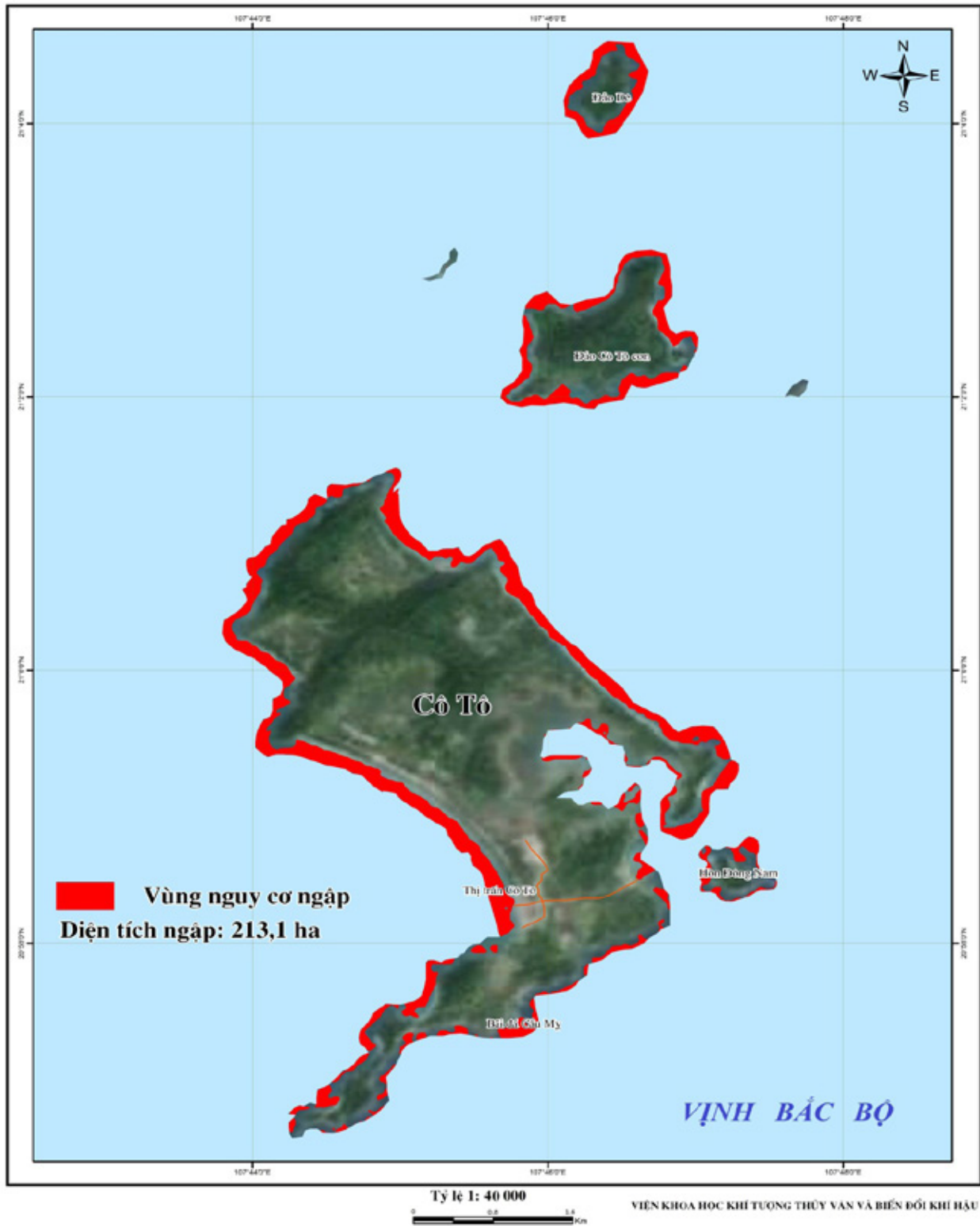
Hình C38. Bản đồ nguy cơ ngập úng với mực nước biển dâng 100 cm, đảo Cô Tô, tỉnh Quảng Ninh
