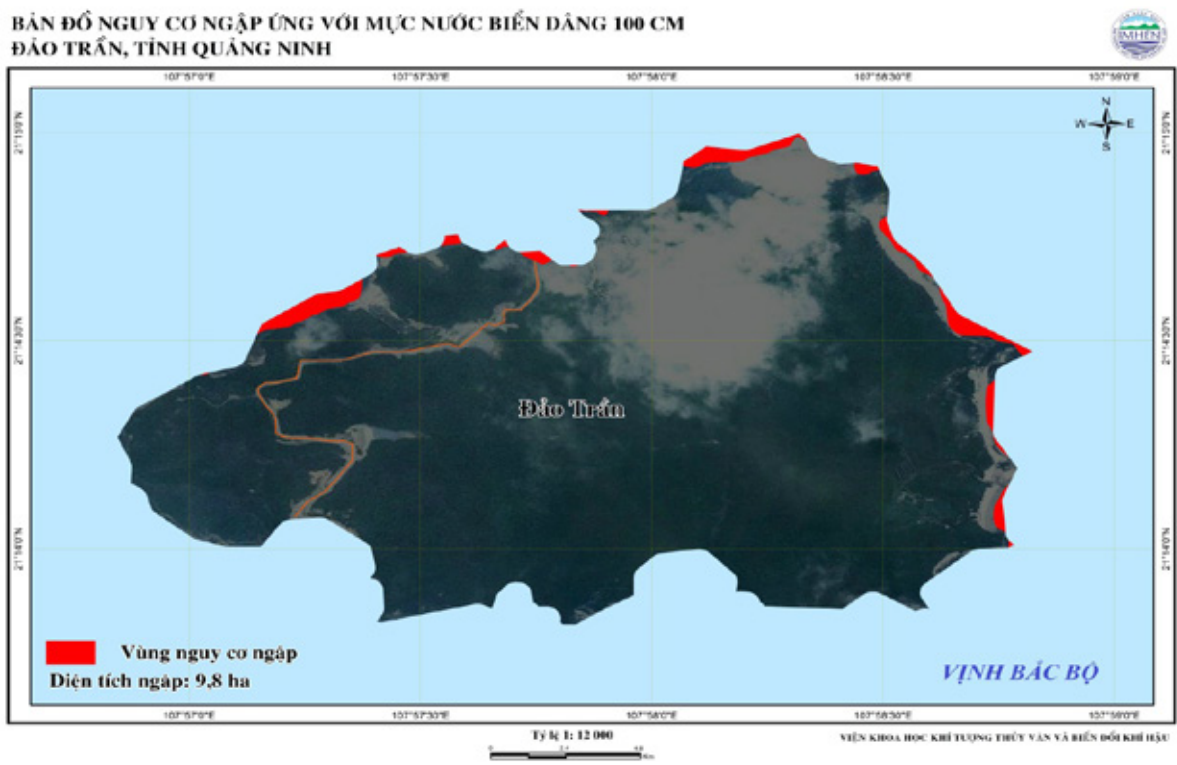
Hình C35. Bản đồ nguy cơ ngập ứng với mực nước biển dâng 100 cm, đảo Trần, tỉnh Quảng Ninh
