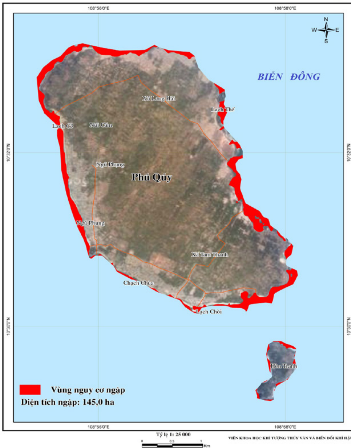
Hình C42. Bản đồ nguy cơ ngập úng với mực nước biển dâng 100 cm, đảo Phú Quý, tỉnh Bình Thuận
