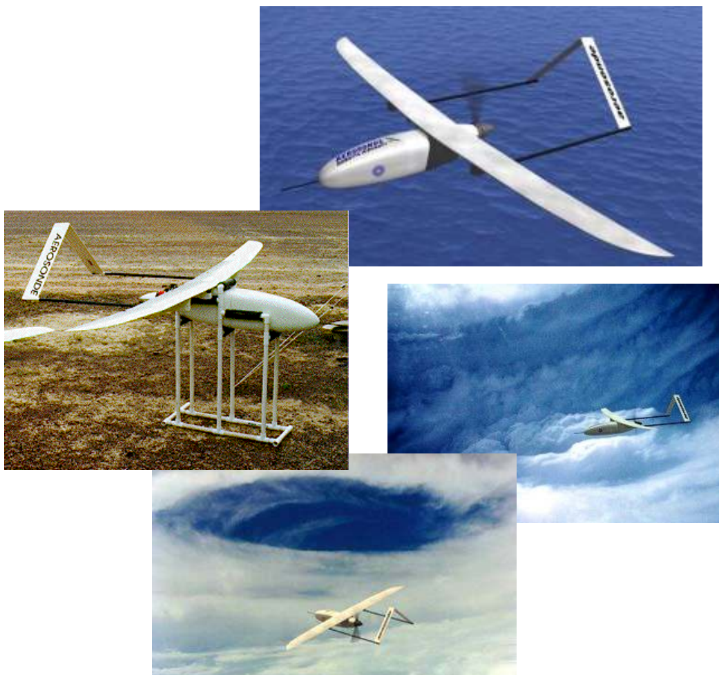
Hình 7.4: Thiết bị bay không người lái được trang bị máy ảnh để thu thập không ảnh ở độ cao trung bình và thấp
